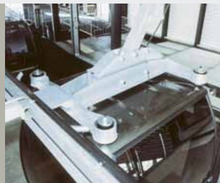
Виброизоляционная прокладка для кабин
